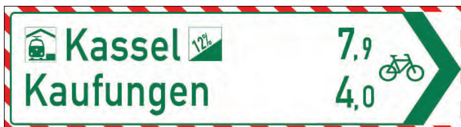
Abb. 3-15: Zielwegweiser für längerfristige Umleitungen
