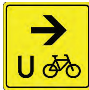
Abb. 3-12: Standard Umleitung mit Zwischenwegweiser
