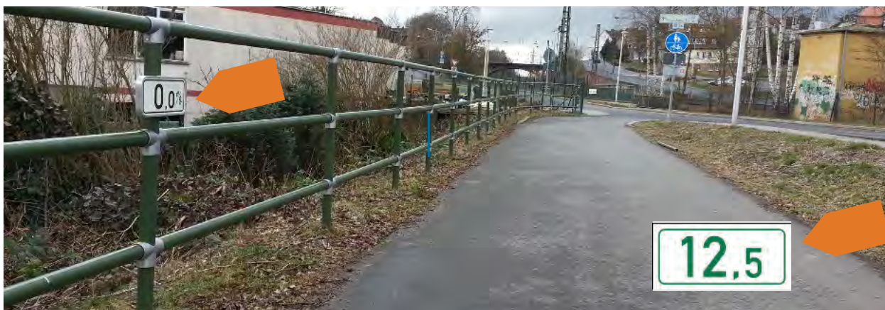
Abb. 4-14: Foto einer Stationierung mit Kilometerangabe
