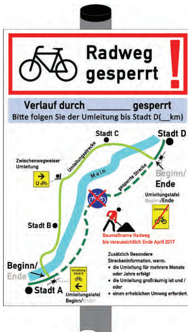
Abb. 3-14: Umleitungstafel am Beginn der Umleitung
