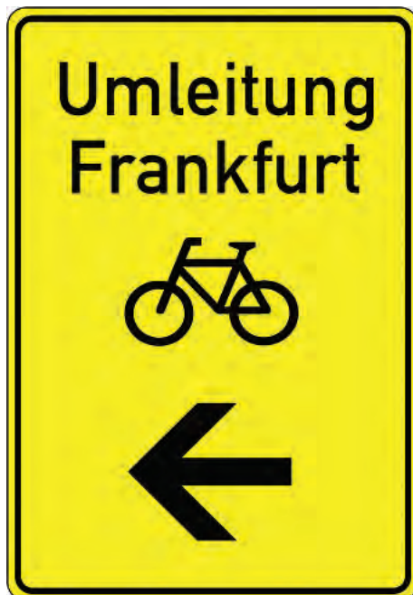
Abb. 3-11: Umleitung auf wichtigen Haupttradrouten: Zwischenwegweiser mit Zielangabe
